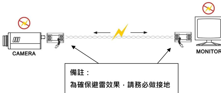
**注意事項：**請確實將 SP009T 接地線連接避雷接地，以達最佳避雷效果。
